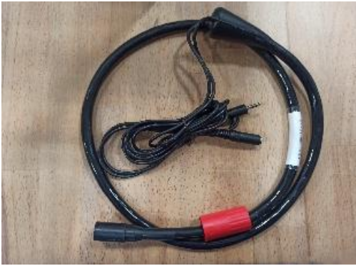
Fig. 16. MLM test loop cable
